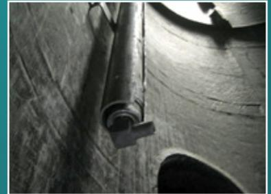
Lanza de inyección de O<sub>2</sub> líquido
