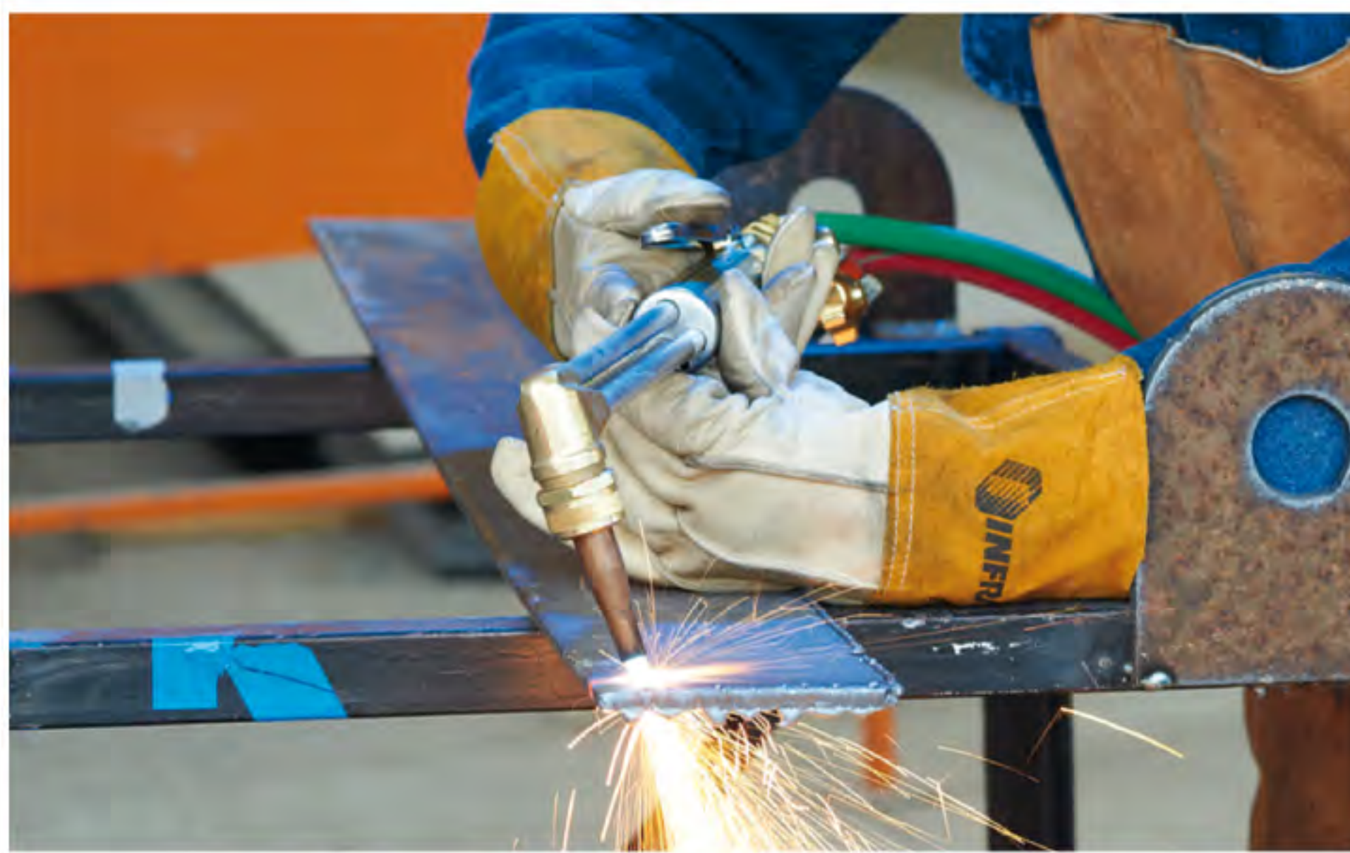
Soldadura y corte oxi-combustible
