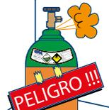
Si detecta alguna fuga en la válvula de un cilindro, mueva éste a un área abierta y lejos de cualquier fuente de ignición (calor, chispas, flamas); coloque señalamientos de prevención y llame a INFRA®.
