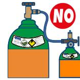
El trasvase de gases está prohibido. El llenado de cilindros sólo puede realizarlo INFRA®, por el alto riesgo de contaminación y manejo de altas presiones.
