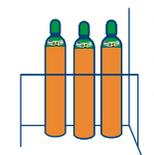
Los cilindros que no se encuentren en uso, deben almacenarse en nido, posición vertical, con sujeción adecuada y capuchones colocados.
