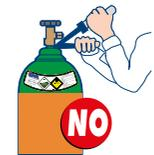
Prohibido cambiar o forzar las conexiones del cilindro o dewar; si estas no se acoplan correctamente con las de sus equipos o líneas de consumo, llame a INFRA®.
