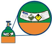
Antes de usar el cilindro, verifique la etiqueta y el color del cuerpo y ojiva, para comprobar que contenga el gas requerido. No reciba cilindros de dudosa procedencia.
