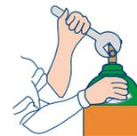
Apretar de más la conexión, puede afectar o deformar las válvulas; utilice la herramienta adecuada y exclusiva para la conexión.
