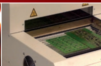
Soldadura en hornos de reflujo (SMT)
