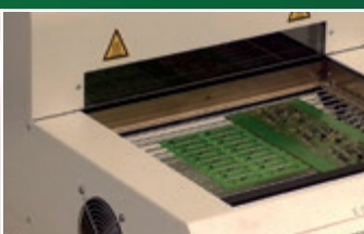
Soldadura en hornos de reflujo (SMT)
