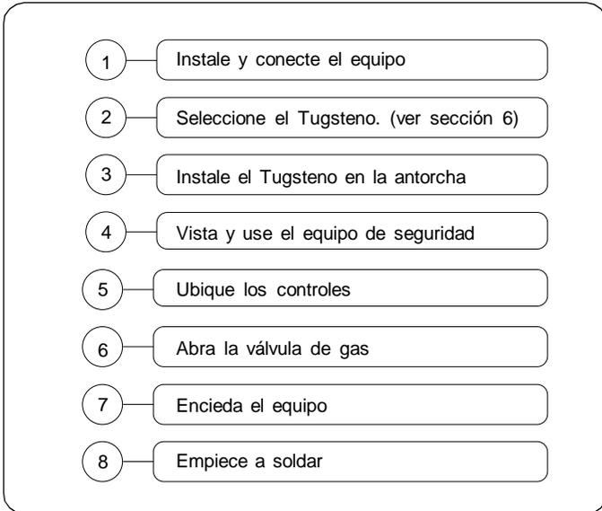
FIGURA 4-18. SECUENCIA PARA PROCESO GTAW Y PROCESO GTASW.
