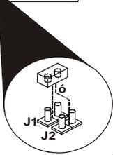
FIGURA 4-14. CONTROL DE PULSOS POR SEGUNDO
