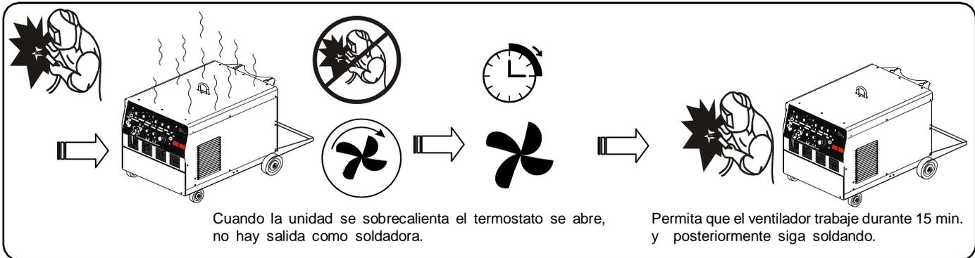
Cuando la unidad se sobrecalienta el termostato se abre, no hay salida como soldadora.
