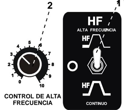
FIGURA 4-5. CONTROLES DE ALTA FRECUENCIA
