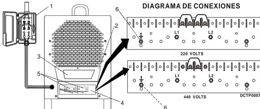
Los puentes conectores permiten la operación sobre diferentes voltajes de alimentación (220/440 Volts) y son colocados de fábrica para el voltaje más alto de suministro (440 Volts). Verifique el voltaje de suministro disponible al sitio. Abra la puerta de acceso en el panel trasero para verificar la posición de los puentes.
