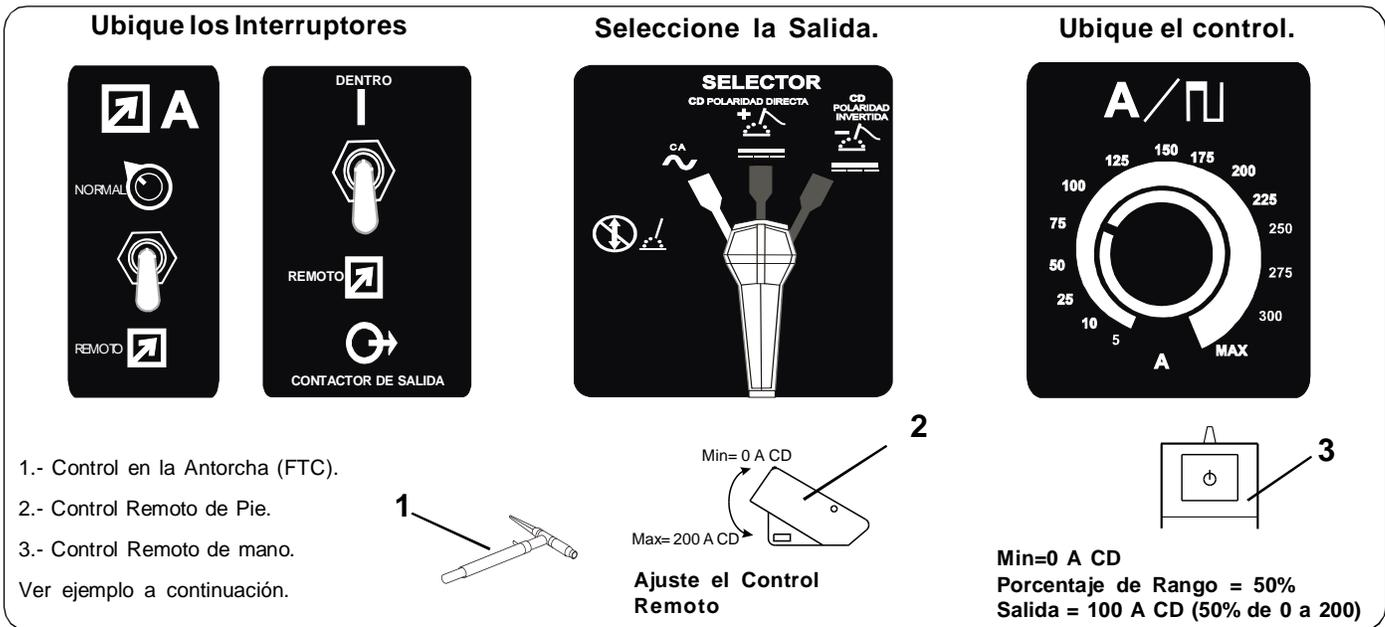
FIGURA 4-8. EJEMPLO DE COMBINACIONES DE CONTROL REMOTO DE CORRIENTE
